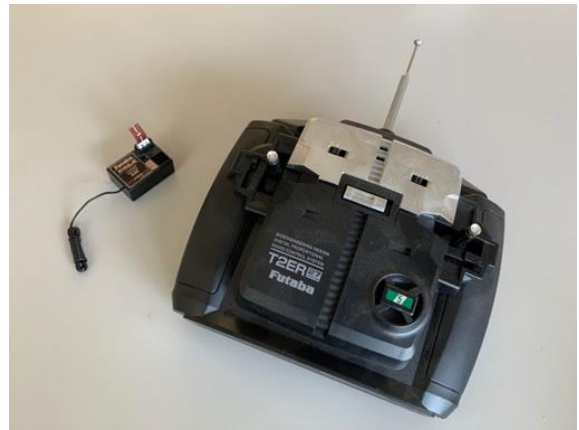
市售 3 通道 27MHz 板型遙控收發器
